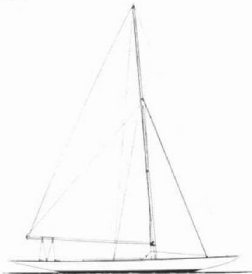
Gr. Segel 37,30 qm, Vorsegel \triangle 8,50 qm, am Wind 45,80 qm. Maßstab: 1 : 160.
